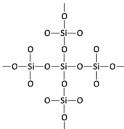
*Рис. 6. Кристаллическая структура кварца*
